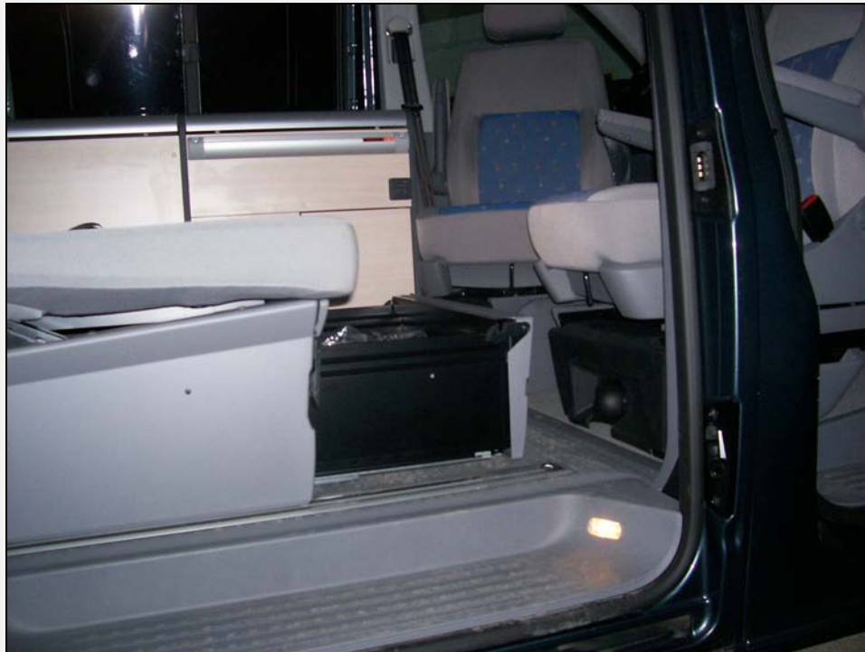
ubicación calefacción estacionaria bajo asiento copiloto
